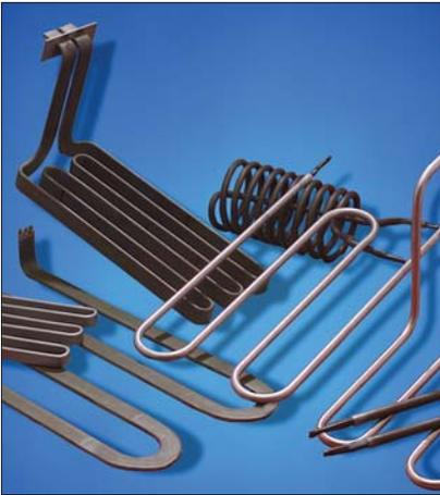
瓦特隆的管式加热器有圆形截面 (WATROD) 及扁平截面 (FIREBAR) 两种型式，主要用于直接浸入液体（例如水、油、溶剂、生产溶液、熔融材料）以及各种气体。通过在液体或流体过程中产生所有热量，这些加热器几乎可以达到 100% 的能量效率。这些多功能加热器还可制成各种形状，可用于辐射加热以及接触面加热等应用场合。可提供 UL<sup>®</sup> 以及 CSA 认证的元件。
