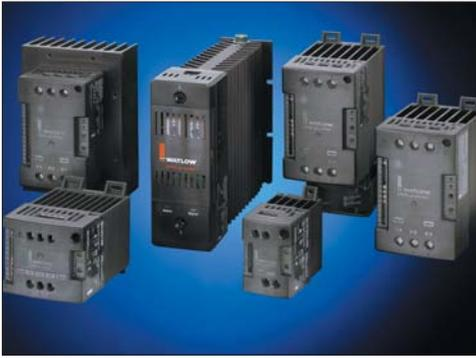
瓦特隆固态功率控制器可满足 PID 温度控制器所需要的快速转换功能，并具有最佳的系统性能和最长的使用寿命。瓦特隆功率控制器有1相、3相/2脚及3脚这几种结构，可以满足大多数工业加热器的应用。随机、过零或相角触发方式使功率控制器符合应用要求。DIN-A-MITE®功率控制器提供了 18~100 安培范围内的 DIN 导轨装配包——可替代水银位移继电器。QPAC 功率控制器额定电流 1000 安培，以满足大型生产流程中的加热需要。基于 POWER 系列功率控制器的规格从 65 至 250 安培。POWER 系列提供了一个大型系统和加热器诊断功能，以及有关部门的认证。CZR 系列是经 CSA、VDE 和 UL® 认证的接触器，其单相额定电流为 18 至 50 安培。单个固态继电器的电流范围是 10 至 75 安培。E-SAFE® 继电器是 3 极混合固态继电器/机械继电器，其额定电流为 20 和 40 安培，并列于 UL®-508 和 C-UL® 的认证文件中。在工作电流范围内 E-SAFE® 是一个很好的水银位移继电器替代品。
