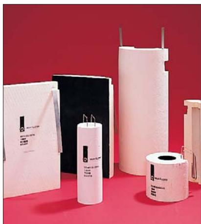
陶瓷纤维加热器是由高温铁—铬—铝加热元体 (ICA) 与陶瓷纤维绝缘材料制成。我们可提供大量现货、标准以及定制形状陶瓷纤维加热器, 以将“绝缘式加热”概念应用于您高温、非接触式热辐射应用场合。陶瓷纤维绝缘材料可隔离加热室内的高温与室外环境。该加热器重量轻, 加热速度快, 绝缘性能高, 加热元件可自我支持, 在瓦特隆加热器系列产品中属于加温能力最高的产品。
