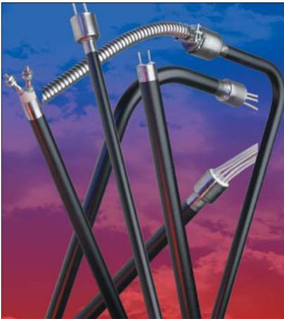
瓦特隆的多芯加热器具有独立区域控制特性，可实现精确的温度分布均匀性，采用轻松配合设计可轻松插入设备或从设备中取出，并有耐极端高温能力。加热器最多可提供 8 个独立控制区，以及可拆卸传感器所需的一至三个内部热电偶套管。可接受客户定制。
