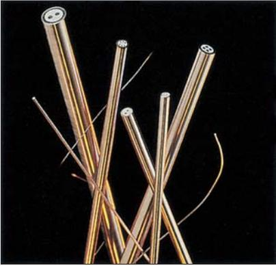
XACTPAK® 的矿物绝缘、金属护套缆线，性能卓越，广泛应用于各工业生产进程的温度测量装置上。金属护套缆线能够保护热电偶避免受到氧化和恶劣环境影响，并且其矿物绝缘材料具有优异的高温绝缘性能。
