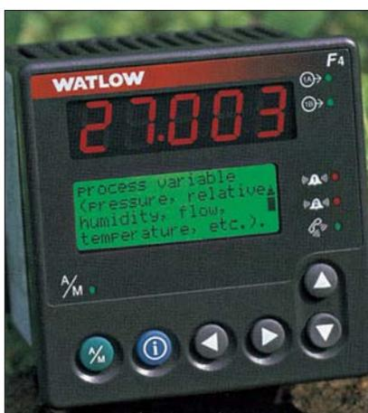
有 1/32、1/16、1/8 和 1/4 四种不同 DIN 尺寸，并通过认证的瓦特隆单回路自整定温度控制器能够自动设置 PID 控制参数，使系统性能达到最优。也可通过手动进行开关，比例、比例积分、比例积分微分模式间切换。所有的瓦特隆自整定控制器的设计与制造都经得起严苛的工业生产环境考验，并享有三年的保修服务。
