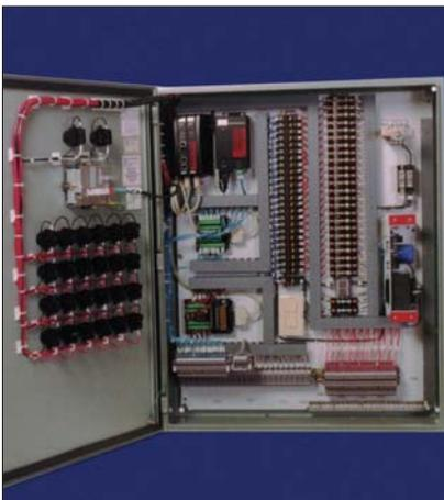
瓦特隆控制面板采用的是工业上领先的瓦特隆生产过程控制器、限位器、警报器和功率控制器。瓦特隆只使用可靠性高的部件以确保较长的使用寿命以及较简便的现场维护。标准设计的控制面板可以在订单后的 10 天之内出货。您可以选择 NEMA 1, 4, 4X, 7 或 12 的任意一种。标准面板可以驱动 480V 交流电、3 相、240KW 的加热系统。定制的面板可以设计应用于 2.5MW 及以上的情况。
