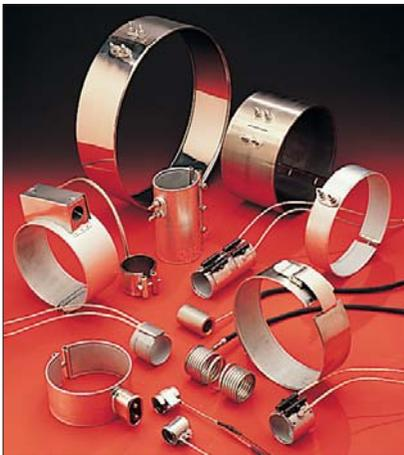
环形加热器及管嘴加热器采用性能优异、柔性好的铠装矿物绝缘材料金属环带制成（已获专利，注册商标为 THINBAND®）或特殊结构的云母绝缘材料金属环带制成，是各类塑料加工设备首选的加热器。
